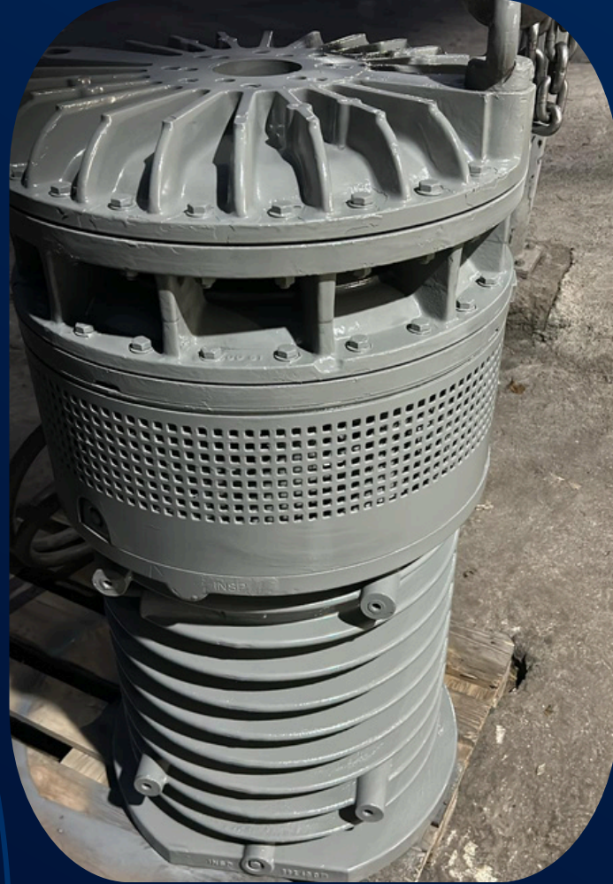
90 KW FLYGT POMPA TAMİRİ
