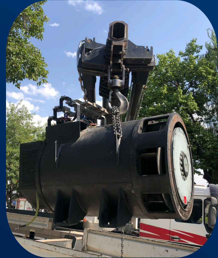
1250 KW MOTOR TAMİR ÇALIŞMASI
